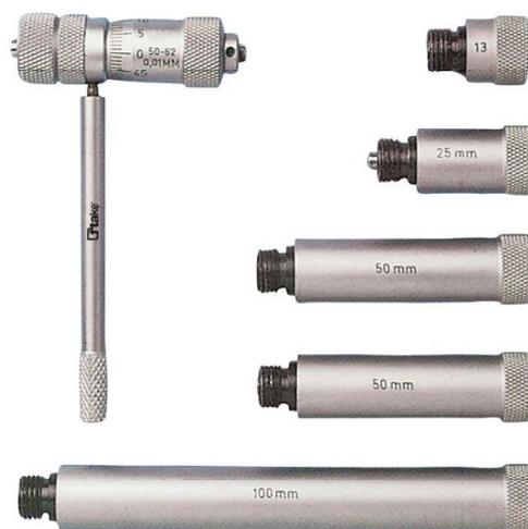
**NOTE:** La taratura comprende la verifica della vite micrometrica e di tutte le prolunghe a corredo; rimane escluso solo il master di azzeramento, a cui è associato un altro Codice (RDT 43.8 o LAT 49.16). **La misura massima dell'asta montata sulla vite micrometrica non deve superare 600 mm.**
