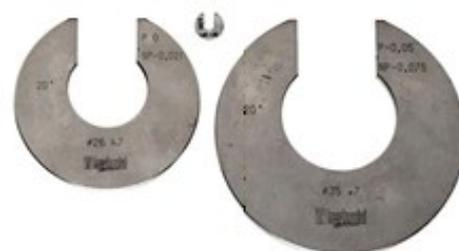
**NOTE: I codici sopra indicati si riferiscono ad una sola forcella, Passa oppure Non Passa.** La taratura delle forcelle Passa oppure Non Passa prevede la verifica di n.3 distanze in tre posizioni diverse, **per un totale di n. 3 misure di distanza.** Metodi diversi di verifica dal metodo standard sono possibili, ma vanno espressamente richiesti.
