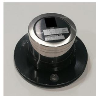
**NOTE:** La taratura è possibile per campioni cilindrici, sferici e a guizzo (ad esempio: calibri ad anello, calibri a tampone, spine, sfere/emisfere ecc.) con diametro compreso tra 1,5 e 300 mm; scostamento massimo di rotondità 1000 µm.
